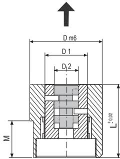
**Insertion et changement de l'insert :** positionner la flèche en alignement avec la flèche de la couronne intermédiaire (entre le 1 et le 12)
