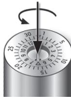
**Changement de jour :** tourner l'insert central pour l'aligner avec la pointe du triangle (entre le 6 et le 7), enfoncer l'insert, et tourner pour amener la flèche gravée sur la couronne intermédiaire en face du repère du jour (ou de l'année ou des dizaines). Relâcher la pression sur l'insert et le faire tourner pour positionner la flèche de l'insert central en face du nombre du mois.
